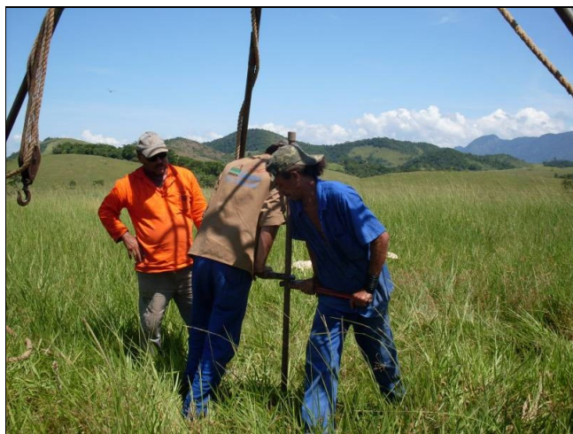
Figura 5.29 - Coleta das Amostras com Trado
